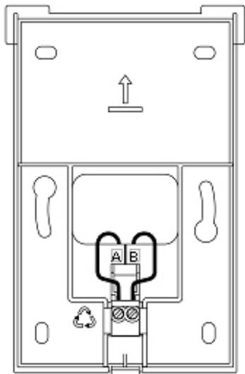
Socle de raccordement (partie supérieure enlevée)
