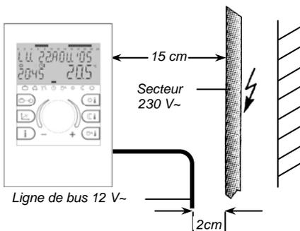
Schéma 1 : Ecarts minimum pour installation électrique
