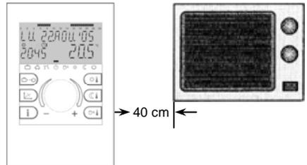
Schéma 2 : distance minimale avec d'autres appareils électriques
