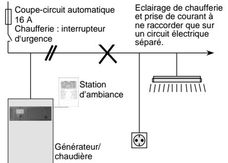
Schéma 3 : Conduite électrique dans la chaufferie
